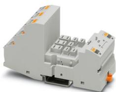
Relaissockel RIF-4..., für Hochleistungsrelais mit 2 oder 3 Wechslern oder 3 Schließern, Push-in-Anschluss, Steckmöglichkeit für Eingangs-/Entstörmodule, zur Montage auf NS 35/7,5
