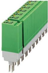
Steckbares Leistungs-Solid-State-Relais, mit Leuchtanzeige und Schutzbeschaltung im Ein- und Ausgangskreis, Eingang: 120 V AC, Ausgang: 15-220 V DC/max. 1 A, steckbar auf Grundklemmenblöcke
