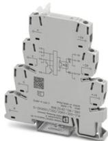
Eingabe-Solid-State-Relais, mit Gleichspannungsausgang-Gegentakt, Übertragungsfrequenz: 100 kHz, mit Leuchtanzeige und Schutzbeschaltung im Ein- und Ausgangskreis, Eingang: 24 V DC, Ausgang: 4 - 18 V DC/50 mA
