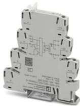
Eingabe-Solid-State-Relais, mit Gleichspannungsausgang-Gegentakt, Übertragungsfrequenz: 100 kHz, mit Leuchtanzeige und Schutzbeschaltung im Ein- und Ausgangskreis, Eingang: 5 V DC, Ausgang: 4 - 18 V DC/50 mA
