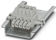
Tragschienen-Busverbinder (TBUS), 5-polig, zur Brückung der Versorgungsspannung, aufschraubbar auf Tragschiene NS 35/... nach EN 60715
