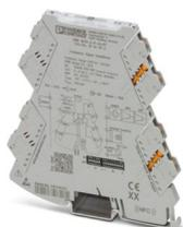
Universell konfigurierbarer Frequenzmessumformer zur Umsetzung von Frequenz- (Hz/rpm) und PWM-Signalen in Normsignale. Sensorspannungen größer als 8,2 V DC, in Verbindung mit MINI MCR-2-SPS-PT 1033201 möglich. Push-in-Anschlussstechnik.
