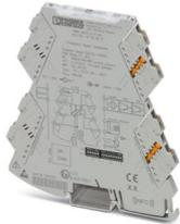
Universell konfigurierbarer Frequenzmessumformer zur Umsetzung von Frequenz- (Hz/rpm) und PWM-Signalen in Normsignale. Sensorspannungen größer 8,2 V DC in Verbindung mit MINI MCR-2-SPS 1033202 möglich. Schraubanschlusstechnik.
