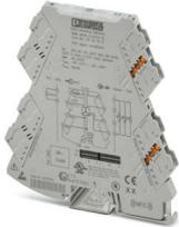
Konfigurierbarer Temperaturmessumformer mit steckbarer Anschlussstechnik für den Anschluss von 2-, 3-, 4-Leiter Widerstandsthermometern und -gebern. Konfigurierbar über DIP-Schalter oder mittels Software. Schraubanschlusstechnik, Standardkonfiguration
