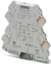
3-Wege-Trennverstärker mit steckbarer Anschlusstechnik zur galvanischen Trennung von uni- und bipolaren Analogsignalen. Eingangssignal: 0 V ... 10 V/±10 V, Ausgangssignal: 0 V ... 10 V/±10 V, Push-in-Anschlusstechnik.
