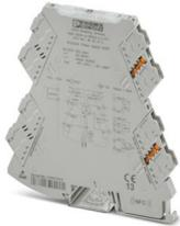
3-Wege-Speisetrenner mit steckbarer Anschlussstechnik. HART-transparent, Eingangssignal 0(4) mA ... 20 mA, Ausgangssignal 0(4) mA ... 20 mA. Das Gerät lässt sich sowohl im Trenner- als auch im Speisetrennerbetrieb verwenden. Push-in-Anschlussstechnik
