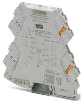
Konfigurierbarer NAMUR-Trennschaltverstärker mit steckbarer Anschluss technik für Näherungsinitiatoren, potenzialfreien und widerstandsbeschalteten Schaltkontakten. 2 Transistorausgänge. Konfigurierbar über DIP-Schalter. Push-in- Anschluss technik.
