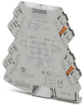
3-Wege-Trennverstärker mit steckbarer Anschlusstechnik zur galvanischen Trennung von Analogsignalen. Eingangssignal: 4 mA ... 20 mA, Ausgangssignal: 0 V ... 10 V, Schraubanschlusstechnik
