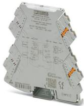
2-kanaliger eingangsschleifengespeister 2-Wege-Trenner mit steckbarer Anschluss-technik zur galvanischen Trennung von Analogsignalen. Eingangssignal = Ausgangssignal: 0(4) mA ... 20 mA. Push-in-Anschluss-technik.
