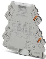
2-kanaliger eingangsschleifengespeister 2-Wege-Trenner mit steckbarer Anschluss-technik zur galvanischen Trennung von Analogsignalen. Eingangssignal = Ausgangssignal: 0(4) mA ... 20 mA. Schraubanschlusstechnik.
