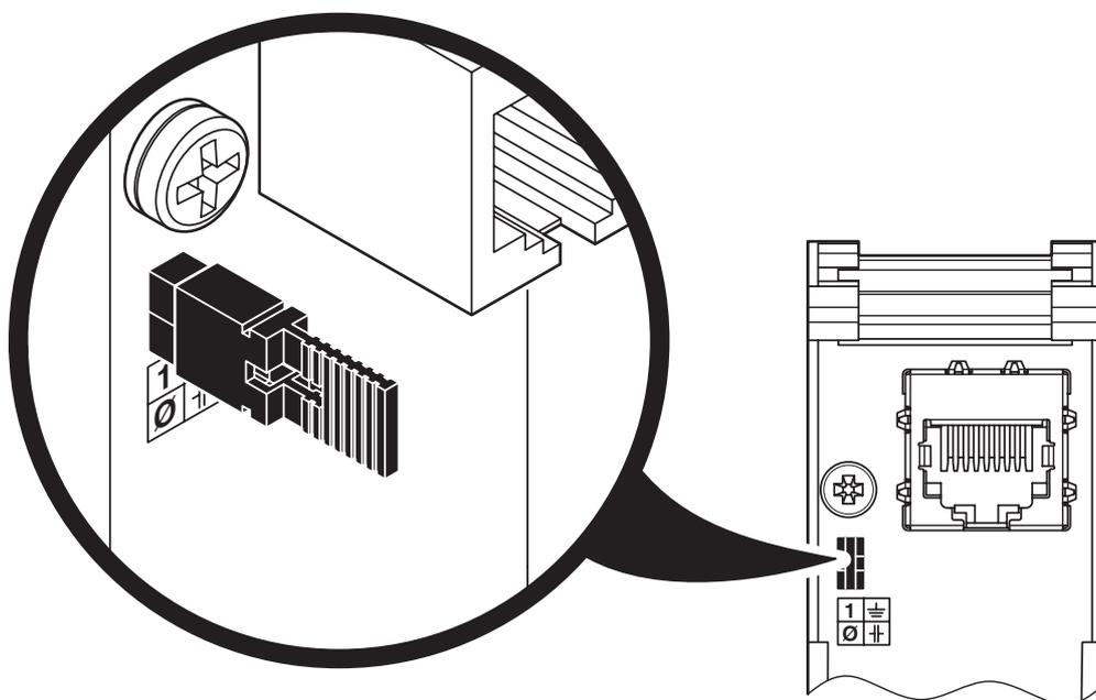
Schirmanschluss direkt an PE
