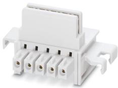
Tragschienen-Busverbinder, Farbe: lichtgrau, Nennstrom: 8 A (parallele Kontakte), Bemessungsspannung (III/2): 125 V, Polzahl: 5, Artikelfamilie: TBUS5-17,5..., Rastermaß: 3,81 mm, Montage: Tragschienenmontage, Verriegelung: ohne, Befestigungsart: ohne, Verpackungsart: verpackt im Karton, Artikel mit vergoldeten Kontakten, Busstecker zur Verbindung mit Elektronikgehäusen, 5 Parallelkontakte
