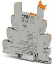
6,2 mm PLC-Grundklemme gegen Störströme bzw. Störspannungen auf der Steuerseite mit Push-in-Anschluss, ohne Relais- oder Solid-State-Relaisbestückung, mit Sensor-Versorgungsspannungsverteilung (BB), 1 Schließer, Eingangsspannung 230 V AC
