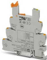
6,2 mm PLC-Grundklemme gegen Störströme bzw. Störspannungen auf der Steuerseite mit Push-in-Anschluss, ohne Relais- oder Solid-State-Relaisbestückung, zur Montage auf Tragschiene NS 35/7,5, mit integriertem RCZ-Filter, 1 Wechsler, Eingangsspannung 120 V AC
