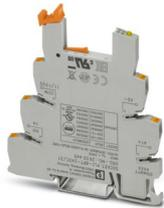
6,2 mm PLC-Grundklemme mit Push-in-Anschluss, ohne Relais- oder Solid-State-Relaisbestückung, zur Montage auf Tragschiene NS 35/7,5, 1 Wechsler, Eingangsspannung 24 V DC
