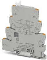
PLC-INTERFACE für NAMUR-Anwendungen, bestehend aus Grundklemme PLC-BPT.../21 mit Push-in-Anschluss und integrierter Schaltung, zur Montage auf Tragschiene NS 35/7,5, Ausgang plusschaltend, Versorgungsspannung 24 V DC
