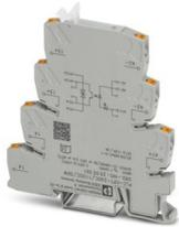
PLC-INTERFACE für Bahnanwendungen, bestehend aus Grundklemme mit Push-in-Anschluss und integriertem Miniatur-Solid-State-Relais, Bereich:  $0,7 \times U_N$  bis  $1,25 \times U_N$ , Temperaturbereich:  $-25 \text{ °C}$  bis  $+70 \text{ °C}$ , 1 Schließer, Eingang: 24 V DC, Ausgang: 12-140 V DC/3 A
