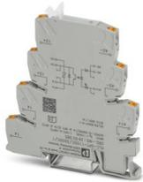
PLC-INTERFACE, integriertes Solid-State-Relais, mit Push-in-Anschluss, zur Montage auf Tragschiene NS 35/7,5, Eingang: 110 V DC, Ausgang: 12-300 V DC/1 A
