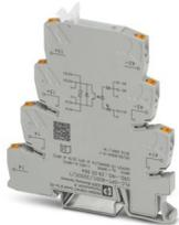
PLC-INTERFACE, integriertes Solid-State-Relais, mit Push-in-Anschluss, zur Montage auf Tragschiene NS 35/7,5, Eingang: 60 V DC, Ausgang: 12-300 V DC/1 A
