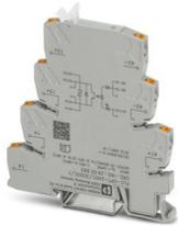
PLC-INTERFACE, integriertes Solid-State-Relais, mit Push-in-Anschluss, zur Montage auf Tragschiene NS 35/7,5, Eingang: 24 V DC, Ausgang: 12-300 V DC/1 A
