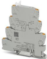
PLC-INTERFACE mit elektronischem Wechslerkontakt, bestehend aus Grundklemme PLC-BPT. ../21 mit Push-in-Anschluss und integriertem Miniatur-Solid-State-Relais, zur Montage auf Tragschiene NS 35/7,5, 1 Wechsler, Eingang: 24 V DC, Ausgang: 3-48 V DC/500 mA
