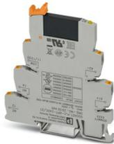
PLC-INTERFACE, bestehend aus Grundklemme PLC-BPT.../21 mit Push-in-Anschluss und steckbarem Miniatur-Solid-State-Relais, zur Montage auf Tragschiene NS 35/7,5, 1 Schließer, Eingang: 24 V DC, Ausgang: 24-253 V AC/ 0,75 A
