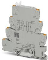
PLC-INTERFACE für TTL-Signal, bestehend aus Grundklemme PLC-O.../TTL mit Push-in-Anschluss und integriertem Solid-State-Relais, zur Montage auf Tragschiene NS 35/7,5, 1 Schließer, Eingang: 24 V DC, Ausgang: TTL (5 V DC)
