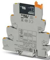
PLC-INTERFACE für Eingabefunktionen, bestehend aus Grundklemme PLC-BPT.../SEN mit Push-in-Anschluss und steckbarem Miniatur-Solid-State-Relais, zur Montage auf Tragschiene NS 35/7,5, 1 Schließler, Eingang: 230 V AC/220 V DC, Ausgang: 3-48 V DC/100 mA
