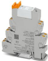
PLC-INTERFACE für Bahnanwendungen, bestehend aus Grundklemme mit Push-in-Anschluss und steckbarem Miniaturrelais mit Mehrlagen-Goldkontakt, Bereich:  $0,7 \times U_N$  bis  $1,25 \times U_N$ , Temperaturklasse TX:  $-40 \text{ °C}$  bis  $+70 \text{ °C}$ , 2 Wechsler, Eingangsspannung 110 V DC
