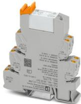
PLC-INTERFACE für Bahnanwendungen, bestehend aus Grundklemme mit Push-in-Anschluss und steckbarem Miniaturrelais mit Leistungskontakt, Bereich:  $0,7 \times U_N$  bis  $1,25 \times U_N$ , Temperaturklasse TX:  $-40 \text{ °C}$  bis  $+70 \text{ °C}$ , 2 Wechsler, Eingangsspannung 72 V DC
