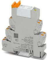
PLC-INTERFACE, bestehend aus Grundklemme PLC-BPT.../21-21 mit Push-in-Anschluss und steckbarem Miniaturrelais mit Leistungskontakt, zur Montage auf Tragschiene NS 35/7,5, 2 Wechsler, Eingangsspannung 230 V AC/DC
