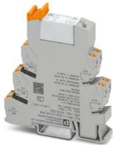
PLC-INTERFACE für Bahnanwendungen und hohe Dauerströme, bestehend aus Grundklemme mit Push-in-Anschluss und steckbarem Miniaturrelais, Bereich:  $0,7 \times U_N$  bis  $1,25 \times U_N$ , Temperaturklasse TX:  $-40\text{ °C}$  bis  $+70\text{ °C}$ , 1 Wechsler, Eingangsspannung 110 V DC
