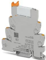
PLC-INTERFACE für Bahnanwendungen, bestehend aus Grundklemme mit Push-in-Anschluss und steckbarem Miniaturrelais mit Leistungskontakt, Bereich:  $0,7 \times U_N$  bis  $1,25 \times U_N$ , Temperaturklasse TX:  $-40\text{ °C}$  bis  $+70\text{ °C}$ , 1 Wechsler, Eingangsspannung 110 V DC
