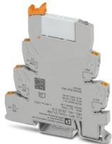
PLC-INTERFACE für Bahnanwendungen, bestehend aus Grundklemme mit Push-in-Anschluss und steckbarem Miniaturrelais mit Leistungskontakt, Bereich:  $0,7 \times U_N$  bis  $1,25 \times U_N$ , Temperaturklasse TX:  $-40 \text{ °C}$  bis  $+70 \text{ °C}$ , 1 Wechsler, Eingangsspannung 72 V DC
