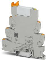
PLC-INTERFACE, bestehend aus Grundklemme PLC-BPT.../21 mit Push-in-Anschluss und steckbarem Miniaturrelais mit Mehrlagen-Goldkontakt, zur Montage auf Tragschiene NS 35/7,5, 1 Wechsler, Eingangsspannung 230 V AC/220 V DC
