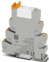
PLC-INTERFACE für hohe Dauerströme, bestehend aus Grundklemme PLC-BPT.../21 HC mit Push-in-Anschluss und steckbarem Miniaturrelais, zur Montage auf Tragschiene NS 35/7,5, Grenzdauerstrom bis 10 A, 1 Wechsler, Eingangsspannung 230 V AC/DC
