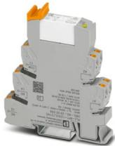
PLC-INTERFACE für hohe Dauerströme, bestehend aus Grundklemme PLC-BPT.../21 HC mit Push-in-Anschluss und steckbarem Miniaturrelais, zur Montage auf Tragschiene NS 35/7,5, Grenzdauerstrom bis 10 A, 1 Wechsler, Eingangsspannung 120 V AC/DC
