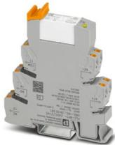
PLC-INTERFACE für hohe Dauerströme, bestehend aus Grundklemme PLC-BPT.../21 HC mit Push-in-Anschluss und steckbarem Miniaturrelais, zur Montage auf Tragschiene NS 35/7,5, Grenzdauerstrom bis 10 A, 1 Wechsler, Eingangsspannung 24 V DC
