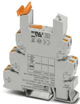
14 mm PLC-Grundklemme für hohe Dauerströme mit Push-in-Anschluss, ohne Relais- oder Solid-State-Relaisbestückung, zur Montage auf Tragschiene NS 35/7,5, 1 Wechsler, Eingangsspannung 230 V AC/DC
