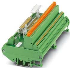
16-kanaliges Modul für Honeywell C300 Baugruppen. Das Modul wird steuerungseitig über D-SUB 37-polig oder FLK 50-polig angesteuert. Feldseitig steht ein Federkraftanschluss (1+, 1-,... 16+, 16-) mit Messertrennung zur Verfügung. Modulbreite: 254 mm
