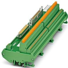
16-kanaliges Modul für Honeywell C300 Baugruppen. Das Modul wird steuerungseitig über D-SUB 37-polig oder FLK 50-polig angesteuert. Feldseitig steht ein Federkraftanschluss (1+, 1C, 1-,...16+, 16C, 16-) mit Messertrennung zur Verfügung. Modulbreite: 258,5 mm
