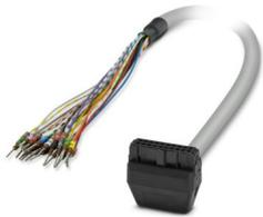
Konfektioniertes Rundkabel; Anschluss 1: Einzeladern (20-polig) (Die Adern sind beschriftet und mit Aderenhülsen versehen); Anschluss 2: IDC/FLK-Buchsenleiste (1x 20-polig, 90 °-Abgang); Kabellänge: 6 m
