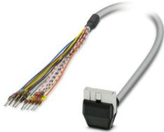
Konfektioniertes Rundkabel; Anschluss 1: Einzeladern (14-polig) (Die Adern sind beschriftet und mit Aderendhülsen versehen); Anschluss 2: IDC/FLK-Buchsenleiste (1x 14-polig, 90 °-Abgang); Kabellänge: 6 m
