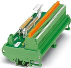
16-kanaliges Modul mit LED für Honeywell C300 Baugruppen. Das Modul wird steuerungsseitig über D-SUB 37polig oder FLK 50-polig angesteuert. Feldseitig steht ein Schraubanschluss (1+, 1-,...16+,16-) mit Messertrennung zur Verfügung. Modulbreite: 170 mm
