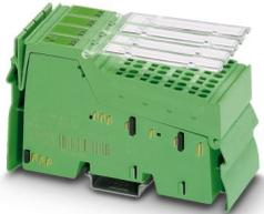
Inline, Temperaturerfassungsklemme, Analoge RTD-Eingänge: 8 (für resistive Temperatursensoren), Anschluss technik: 4-Leiter, Übertragungsgeschwindigkeit im Lokabus: 500 kBit/s, Schutzart: IP20, inklusive Inline-Steckern und Beschriftungsfeldern
