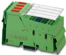
Inline, Digitalausgabeklemme, Digitale Ausgänge: 16, 24 V DC, Anschlusstechnik: 3-Leiter, Übertragungsgeschwindigkeit im Lokalbus: 500 kBit/s, Schutzart: IP20, inklusive Inline-Steckern und Beschriftungsfeldern
