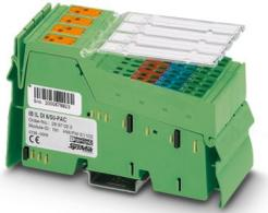
Inline, Digitaleingabeklemme, Digitale Eingänge: 8 (S0-Zähleingänge), 24 V DC, Anschlusstechnik: 4-Leiter, Übertragungsgeschwindigkeit im Lokalbus: 500 kBit/s, Schutzart: IP20, inklusive Inline-Steckern und Beschriftungsfeldern
