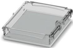
Tragschienengehäuse für den Einsatz in Installationsverteilern nach DIN 43880, transparenter Schwenkdeckel, plombierbar, inklusive Einlegeblende, Breite: 53,6 mm, Höhe: 45 mm, Tiefe: 8 mm, Farbe: lichtgrau (ähnlich RAL 7035)
