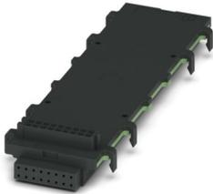
Tragschienen-Busverbinder, Farbe: schwarz, Nennstrom: 3 A (Summenstrom max. 25 A), Bemessungsspannung (III/2): 30 V, Polzahl: 16, Artikelfamilie: BC 107,6..., Rastermaß: 2,54 mm, Montage: Tragschienenmontage, Verriegelung: ohne
