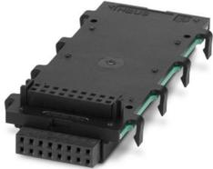
Tragschienen-Busverbinder, Farbe: schwarz, Nennstrom: 3 A (Summenstrom max. 25 A), Bemessungsspannung (III/2): 30 V, Polzahl: 16, Artikelfamilie: BC 71,6.., Rastermaß: 2,54 mm, Montage: Tragschienenmontage, Verriegelung: ohne
